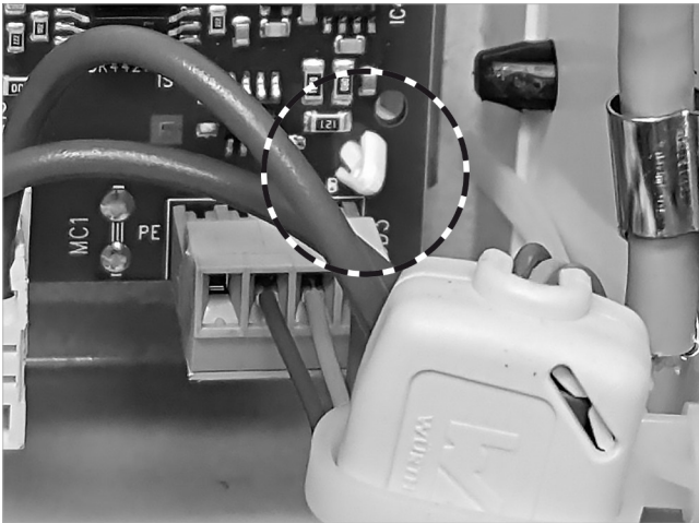
Abb. 5: Abstandsklammern zur Befestigung der Inverterplatine auf dem Halteblech (Beispiel)
